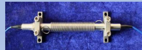
光纤光栅应变传感器 测量精度 0.1\% \text{F}\cdot\text{S}
